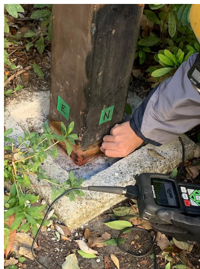
超音波探傷器による肉厚測定の様子
