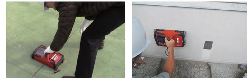
建物や地中に埋設された配線、配管などを傷つける事故を防ぐため、新たにレーダー探査技術を活用しています。
