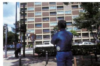
外壁詳細調査のため、赤外線カメラで外壁(タイル等)の温度変化を調査します。
