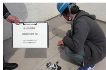
ウレタン塗膜防水層から試験片を切り取り採取し、性能評価を行います。
